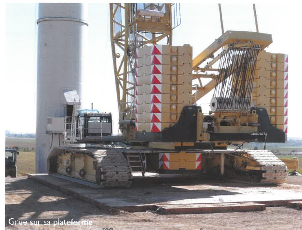
Figure 338 : Illustration d'une grue sur plateforme de montage utilisée pour l'assemblage des éoliennes
